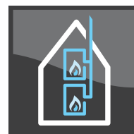
Decentrale verwarmingsapparaten die op dezelfde schoorsteen zijn aangesloten (gasgeisers e.d.)
