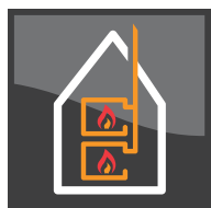
Meerdere stookplaatsen, aangesloten op dezelfde schoorsteen
